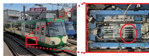
世田谷線300系車両の床下制御機器の破損箇所
